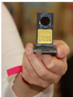
Le dosimètre permet de mesurer le taux de radon.
